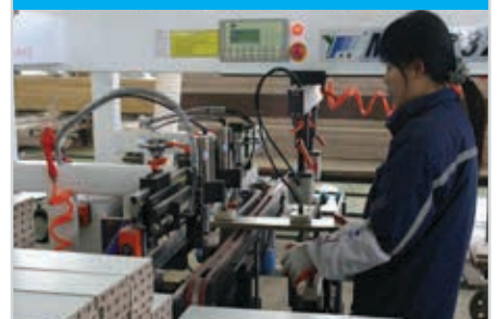
WOOD EDGE DRILLING
